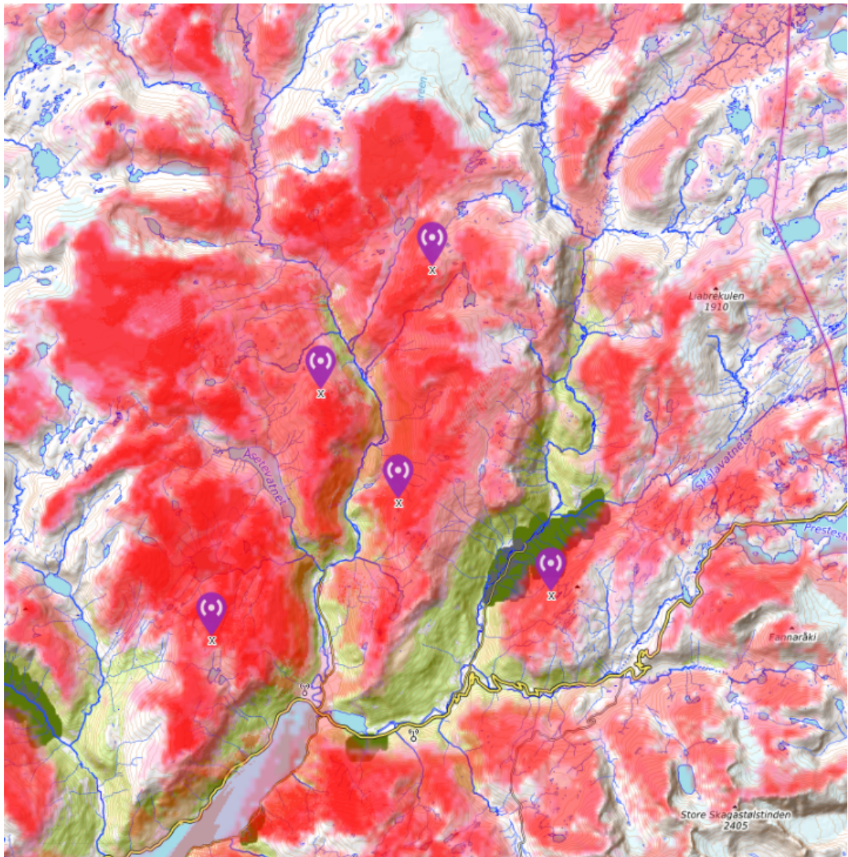
Figur 2: Kart med ønska plassering av basestasjonar og dekningsgrad i terrenget. Dei tre nordlegaste basestasjonane er innanfor Breheimen nasjonalpark, og Mørkridsdalen LVO er i dalen mellom basestasjonane.
