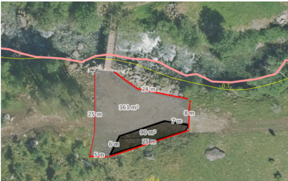
Figur 2: Målsett teikning av plassen ved Kalvatrebrua. Mørk skravur viser område for inngjerda samleke for storfe. Måla på plassen vert større enn skissert i prosjektplanen og er basert på eksisterande inngrep.
