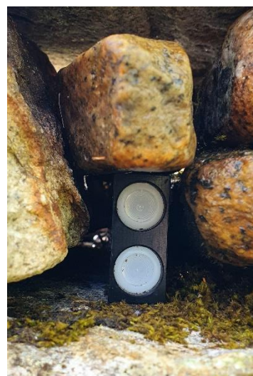
Figur 5 En pyro-sensor innebygd i en varde
