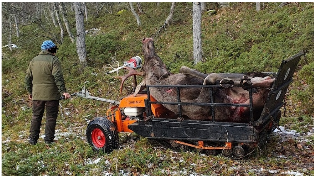
Figur 2. Elgtrekk, beltedrift, styrestag med gummi hjul (uten drift). I praktisk bruk.
