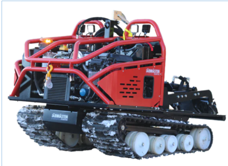
Figur 5. Jernhest for skogsdrift. Radiostyrt med hydraulisk styring av beltene.
