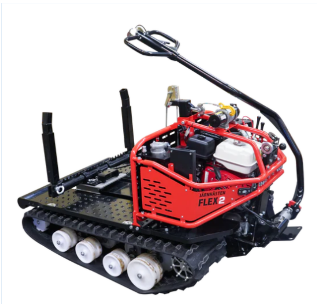
Figur 4. Jernhest for skogsdrift. Styrestag med hydraulisk styring av beltene.
