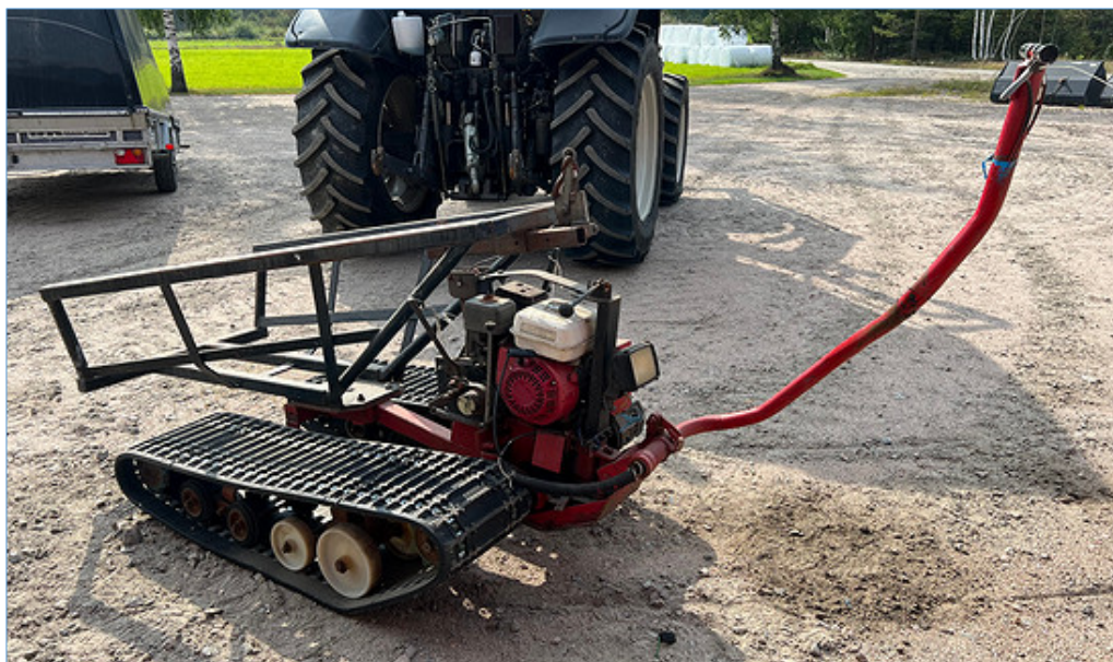
Figur 3. Elgtrekk, beltedrift, styrestag med hydraulisk styring av beltene.
