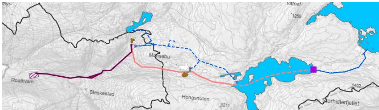
Figur 3-19 Nettilknytningen for Sandvatnet kraftverk er vist med stiplet rosa linje for sjøkabel over Sandvatnet og heltrukken rosa linje for luftledning videre til Kvelvane. Luftledningen videre til Håmo er vist med lilla strek.
