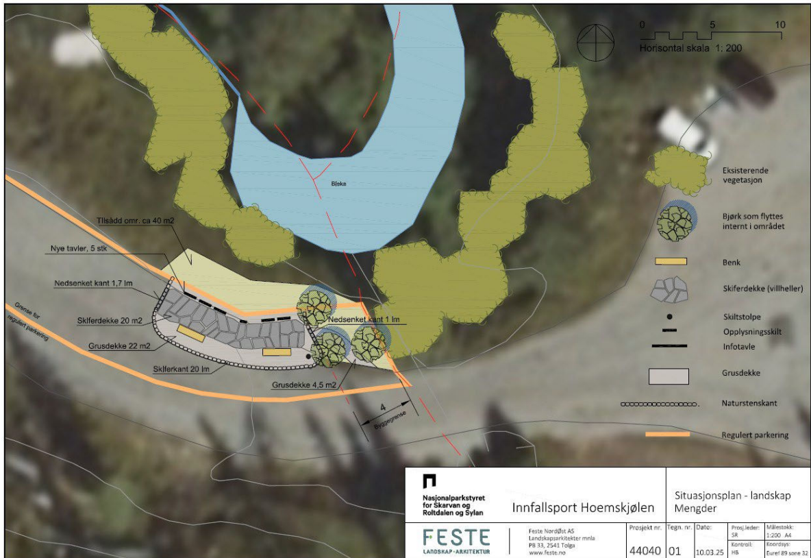
Figur 3: Landscapsplan for innfallsporten med ortofoto bak. Eiendomsgrenser (rød stiplet strek) og regulert parkering (oransje heltrukket linje) er visualisert i planen.
