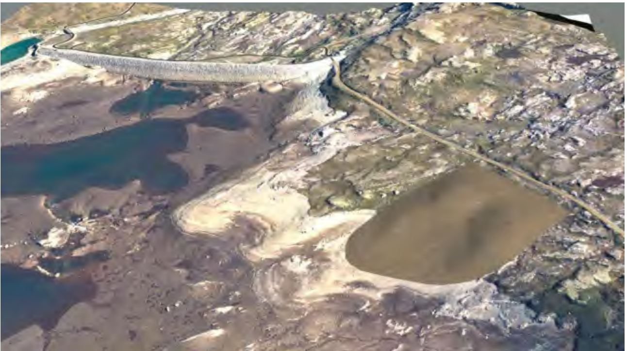
Figur 4-2. Utklipp fra 3D-modell som viser steinbruddsområdet etter uttak av cirka 250 000 fm 3 . Se også egen steinbruddstegning for uttak som ligger vedlagt (Tegning 0012).
